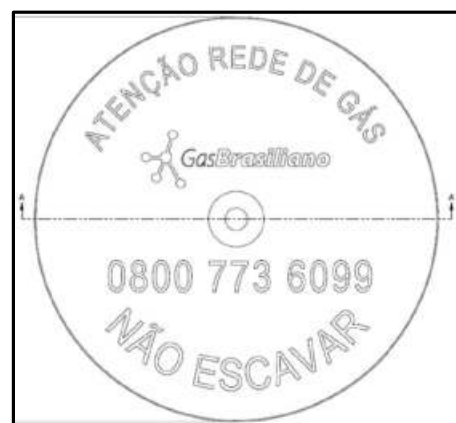
Figura 4 – Modelo marco tipo tachão Fonte: GasBrasiliano, 2019.
