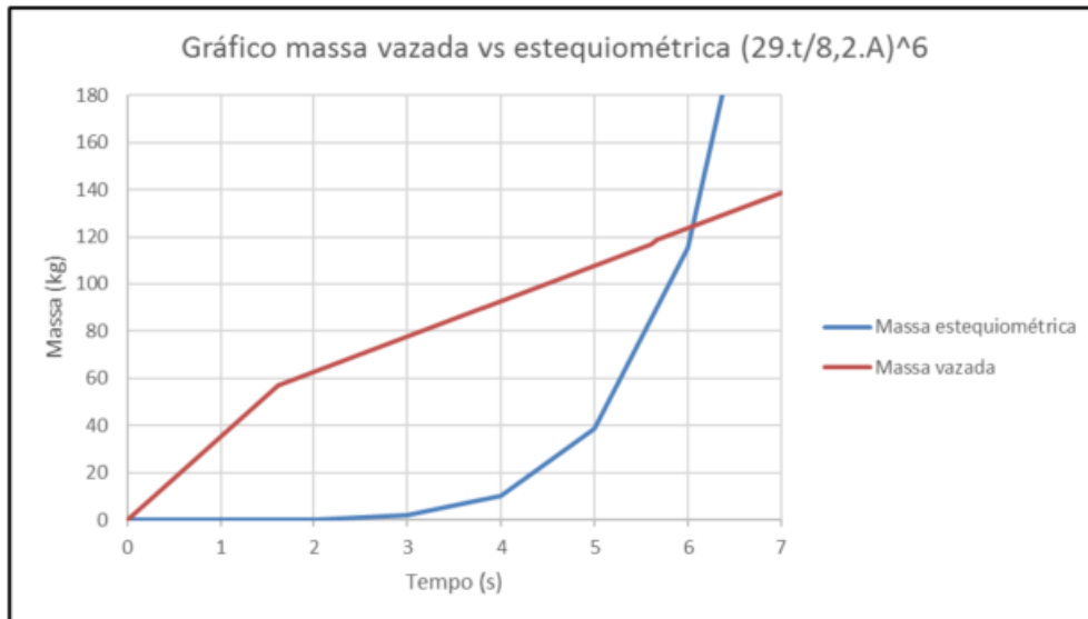
Figura 9 - Gráfico da massa vazada e da massa estequiométrica representada pela equação (29.t/8,2.A)^6 pelo tempo de vazamento
