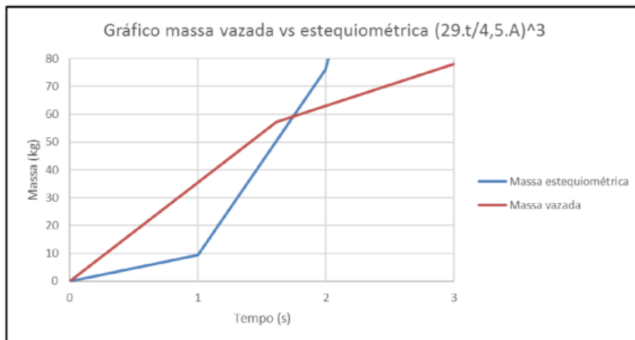
Figura 8 – Gráfico da massa vazada e da massa estequiométrica representada pela equação (29.t/4,5.A)^3 pelo tempo de vazamento
