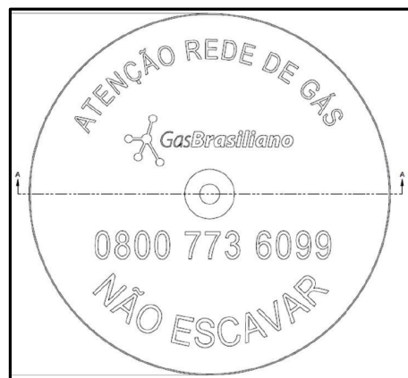
Figura 4 – Modelo marco tipo tachão Fonte: GasBrasiliiano, 2019.
