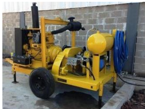
GRANDE PORTE DEMOLIÇÃO DE CONCRETO E PREPARO DE PEÇAS EM AÇO (Pressão máxima de operação 40.000PSI - 2760BAR)
