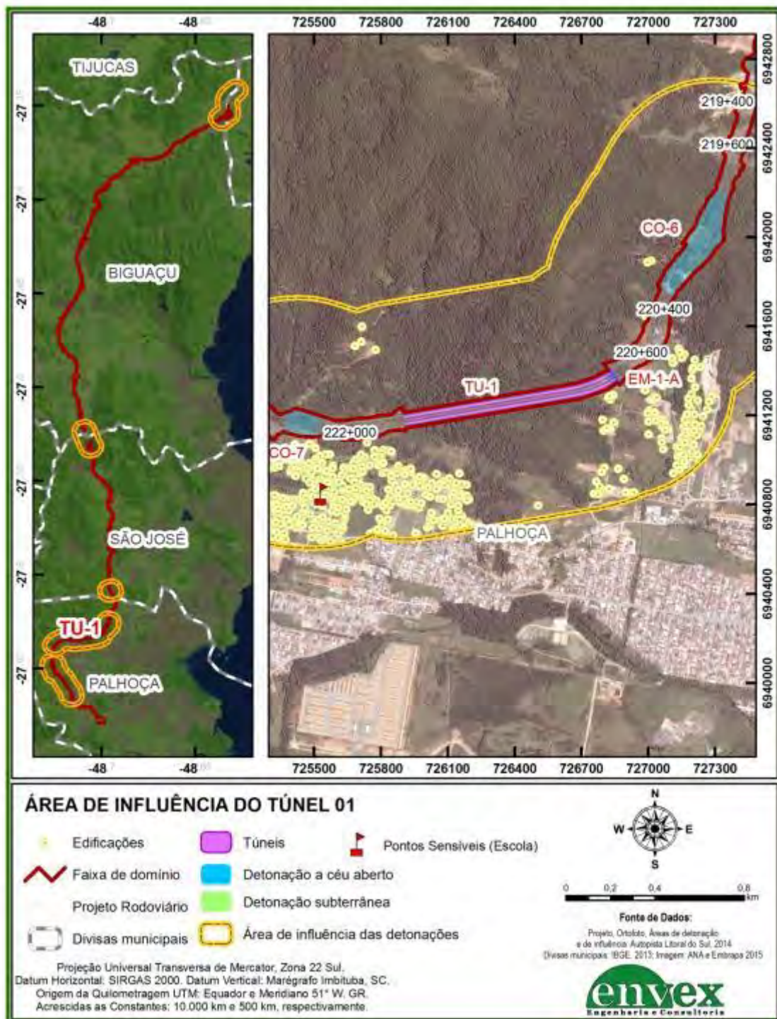
Figura 6. Localização das áreas de detonação do Túnel 1 (EM-1-A, TU-1) e sua zona de influência com respeito ao ruído e vibrações.
