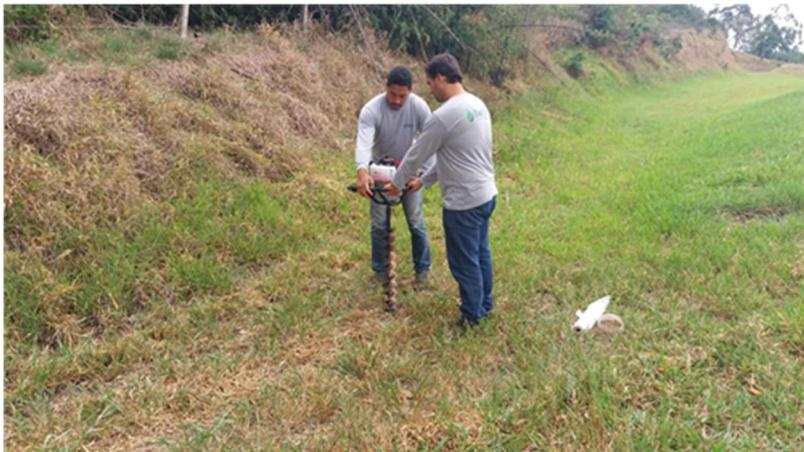
**Figura 61** – Perfuração mecânica do perfil do solo na área experimental da Rodovia Fernão Dias para coleta de amostras para análise de solo.
