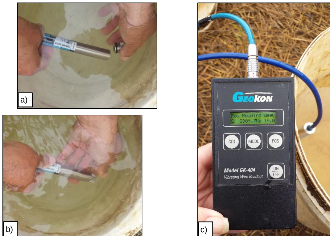
Figura 55 - Instalação da pedra porosa na ponteira do piezômetro (a) pedra porosa sendo colocada na ponteira do piezômetro (b) pedra porosa já na ponteira do piezômetro (c) leitura manual do piezômetro
