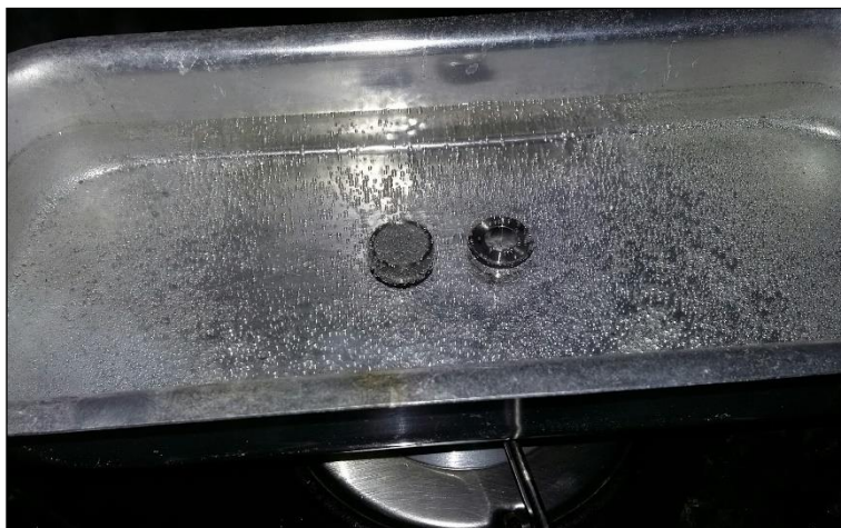
Figura 53 - Saturação da pedra porosa
