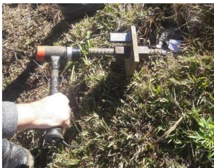
Figura 141 – Ensaios Sonic Echo nos grampos
