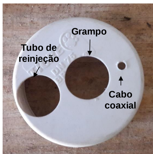
Figura 76 – Caps ou “tampas” utilizados para falhas com ar nos grampos
