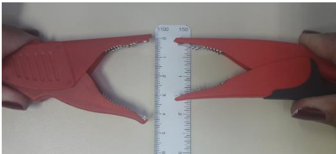
Figura 116 – Abertura das garras utilizadas no ensaio de resistência elétrica
