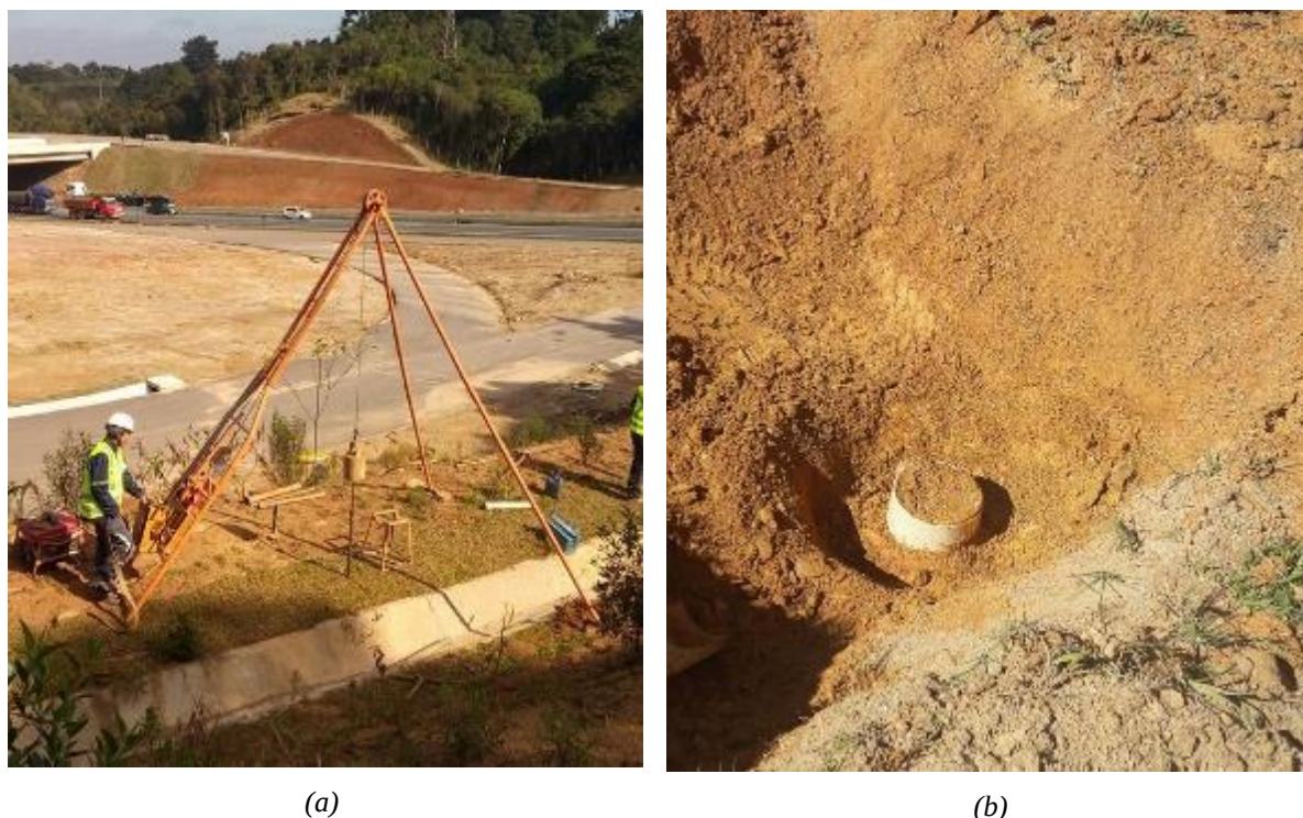
Figura 23 – Caracterização geotécnica do campo experimental: (a) sondagem SPT e (b) coleta de amostras indeformadas
