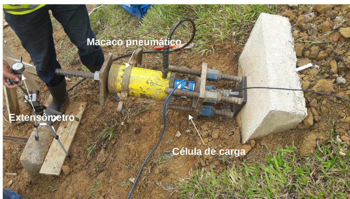
Figura 100 - Sistema para protensão dos tirantes
