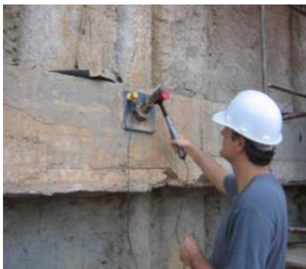
Figura 13 – Realização do Ensaio Sonic Echo
