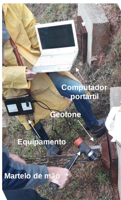
Figura 117 – Equipamentos utilizados no ensaio Sonic Echo
