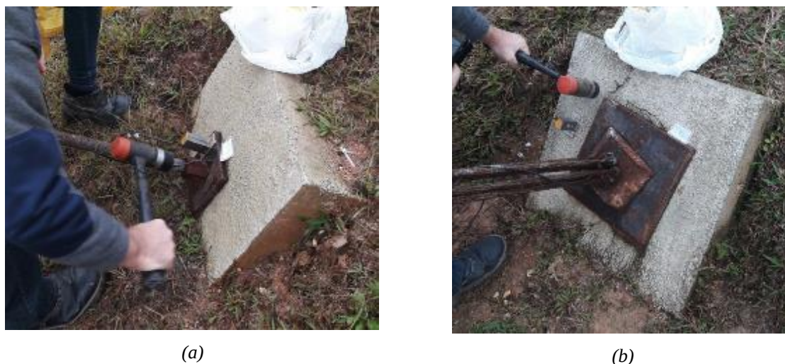
Figura 144 – Variações do ensaio Sonic Echo nos tirantes: (a) Geofone da placa de aço; (b) Geofone na placa de reação de concreto.
