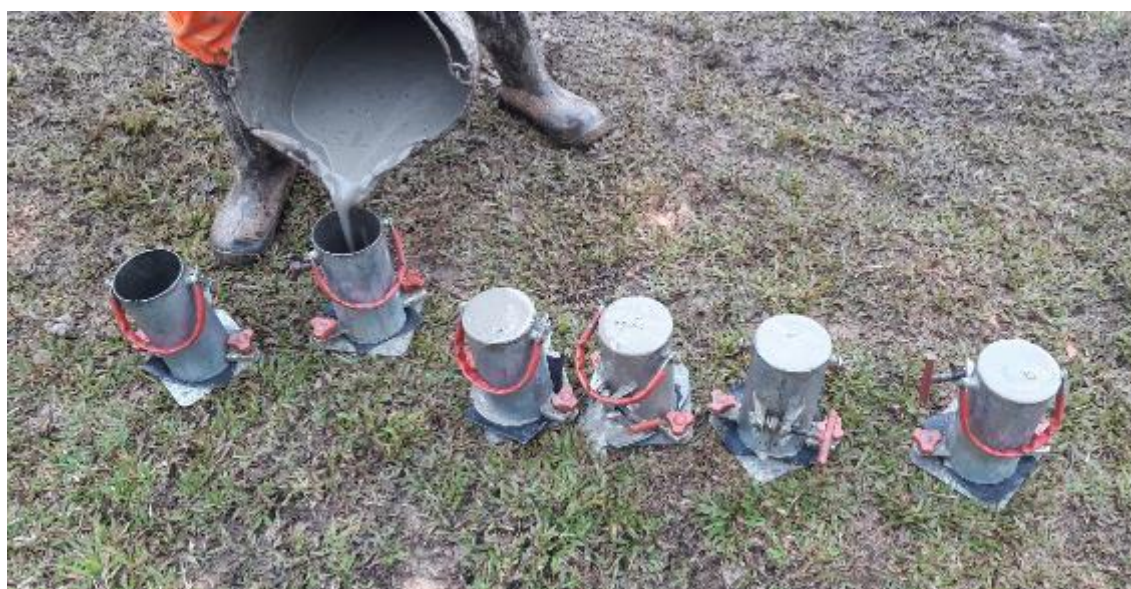
Figura 74 – Coleta de corpos de prova e calda de cimento
