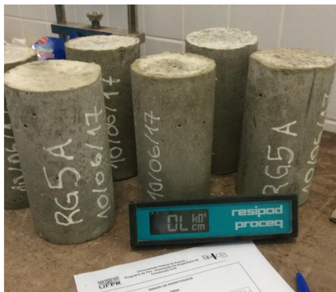
Figura 46 – Equipamento Resipod e corpos de prova da calda de cimento
