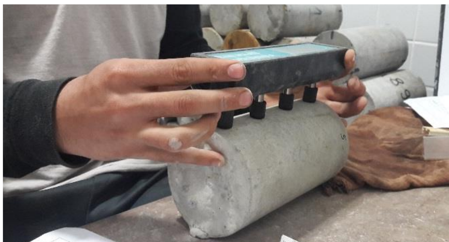
Figura 47 – Ensaio de resistividade elétrica
