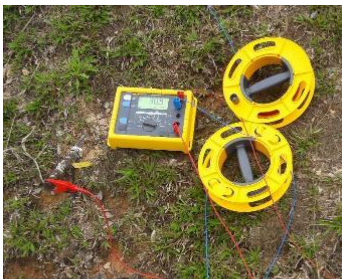
Figura 112 – Equipamento utilizado para medição de resistência elétrica das barras
