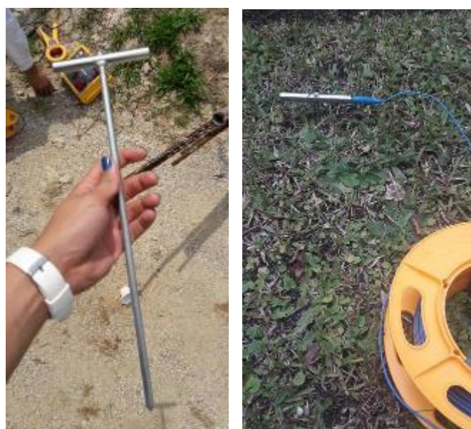
Figura 113 – Hastes metálicas instaladas no solo para leitura da resistência elétrica
