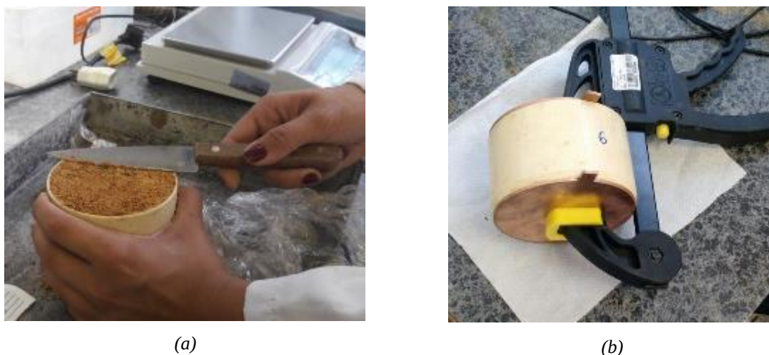
Figura 44 – Ensaio de resistividade elétrica em amostra indeformada: (a) regularização das faces e (b) chapas de cobre.
