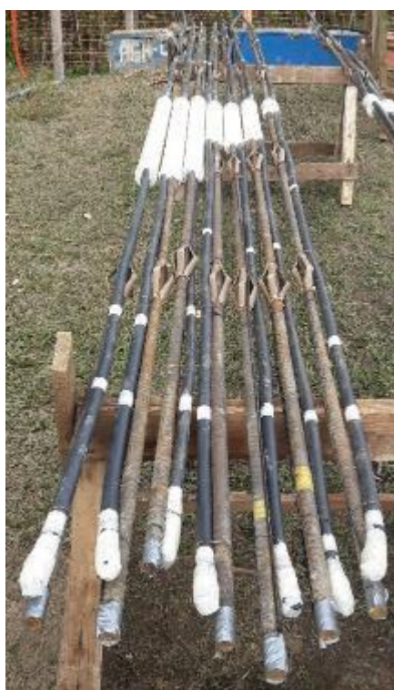
Figura 80 – Grampos com falhas preenchidas com ar
