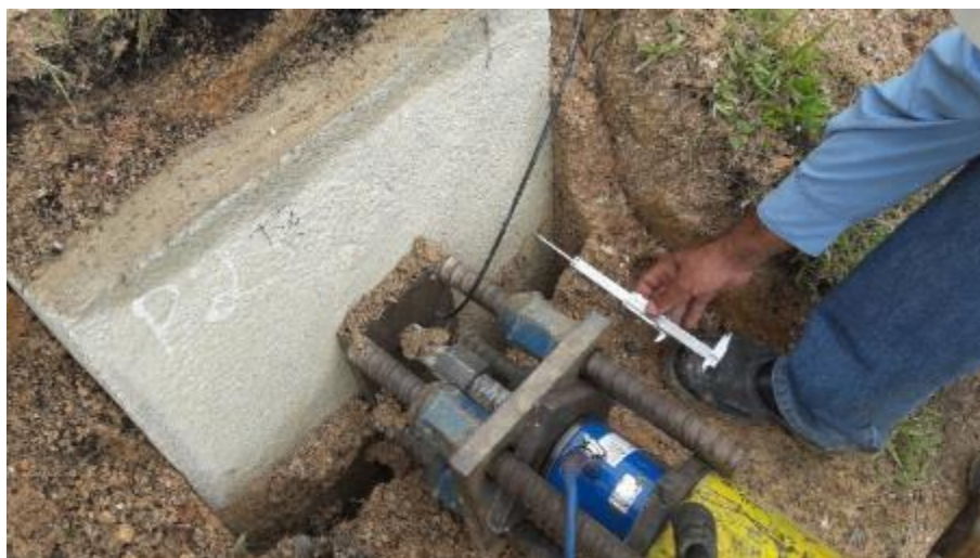
Figura 102 – Leituras do deslocamento com paquímetro
