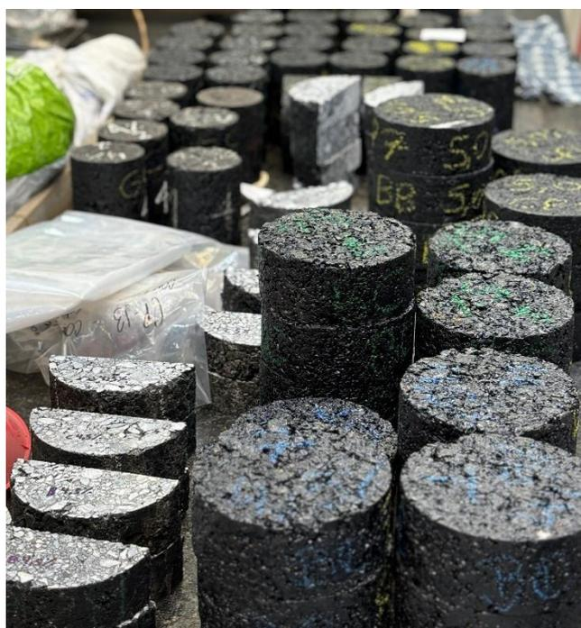
Figura 19 – Diferentes corpos de prova compactados para a pesquisa com o CGS
