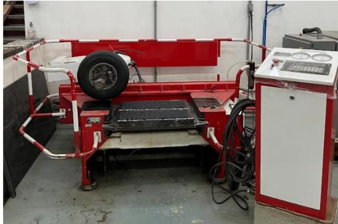
Figura 50 – Mesa compactadora LCPC
