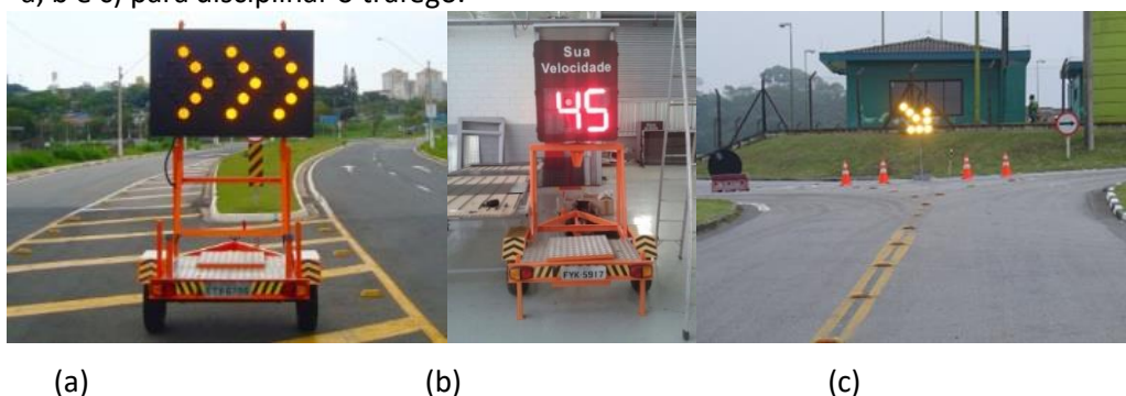
Figura 26.: Painel tipo SETA (a); informador de velocidade/carreta-radar (b); seta luminosa (c)
