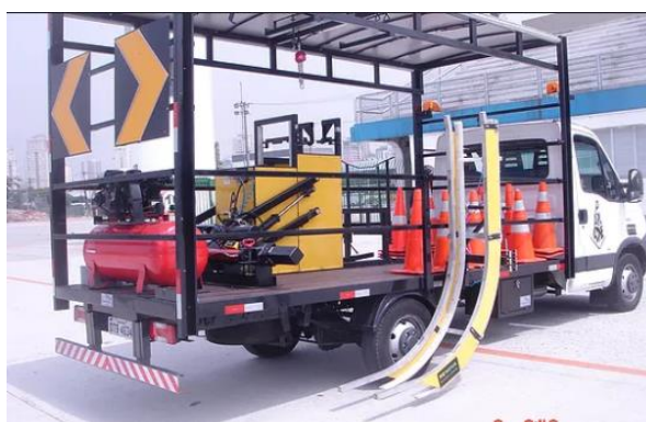
Figura 41.: Solução automatizada para implantação/retirada de cones (papa-cones)
