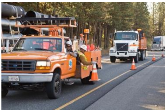
Figura 38.: Solução para implantação/retirada de cones com recuo na carroceria
