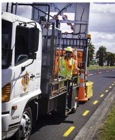
Figura 37.: Solução para implantação/retirada de cones com recuo na carroceria
