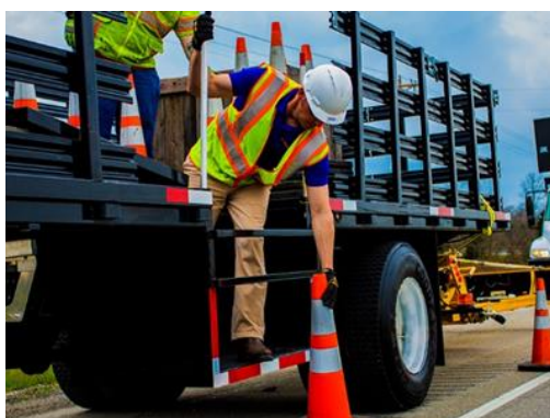
Figura 39.: Solução para implantação/retirada de cones com recuo na carroceria
