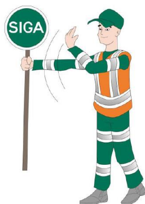
Figura 44.: Operador mantendo sinal de “SIGA” voltado para o fluxo de veículos e gesto de início de circulação
