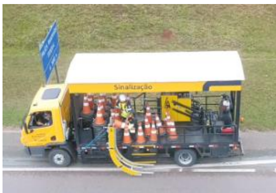
Figura 40.: Solução automatizada para implantação/retirada de cones (papa-cones)
