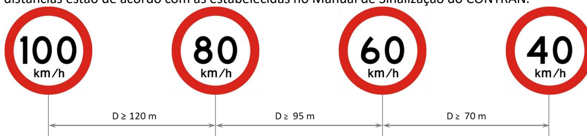
Figura 51.: Distâncias Mínimas necessárias entre placas de velocidade
